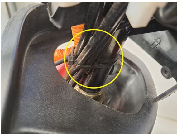
Katkaise kaasukahvan johtoa kiinni pitävä nippuside. (sivuleikkurit).
